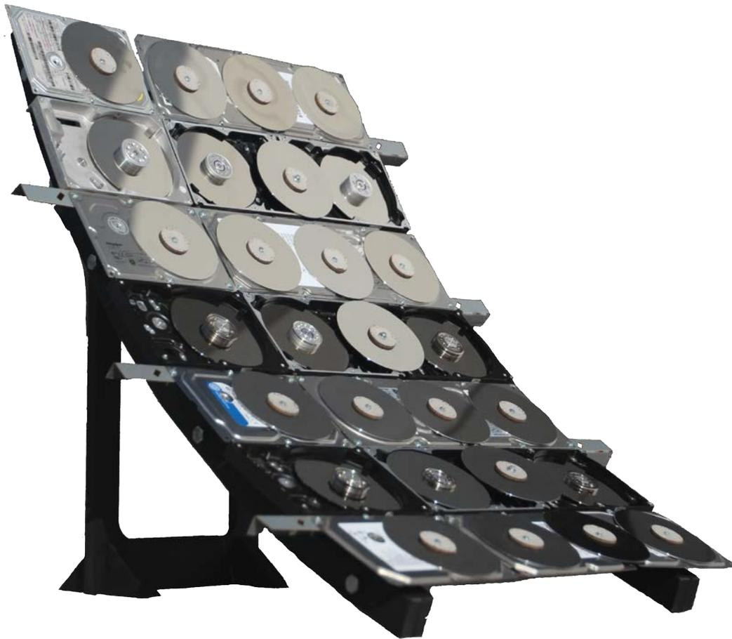
Módulo a escala real del Concentrador Solar a partir de discos HDD
